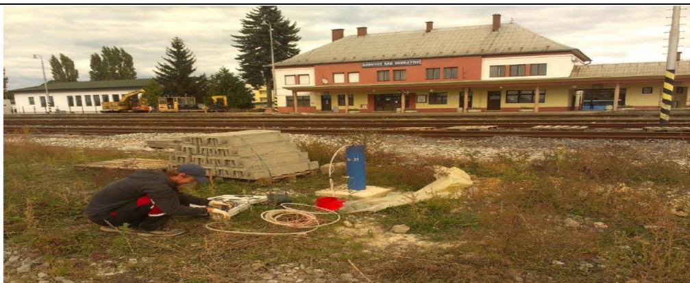
Bánovce nad Bebravou – železničná stanica – odber vzoriek podzemných vôd
